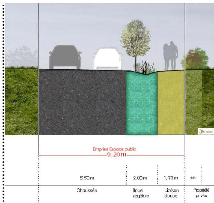
Extrait du plan de composition et profil de voirie – voie principale.
